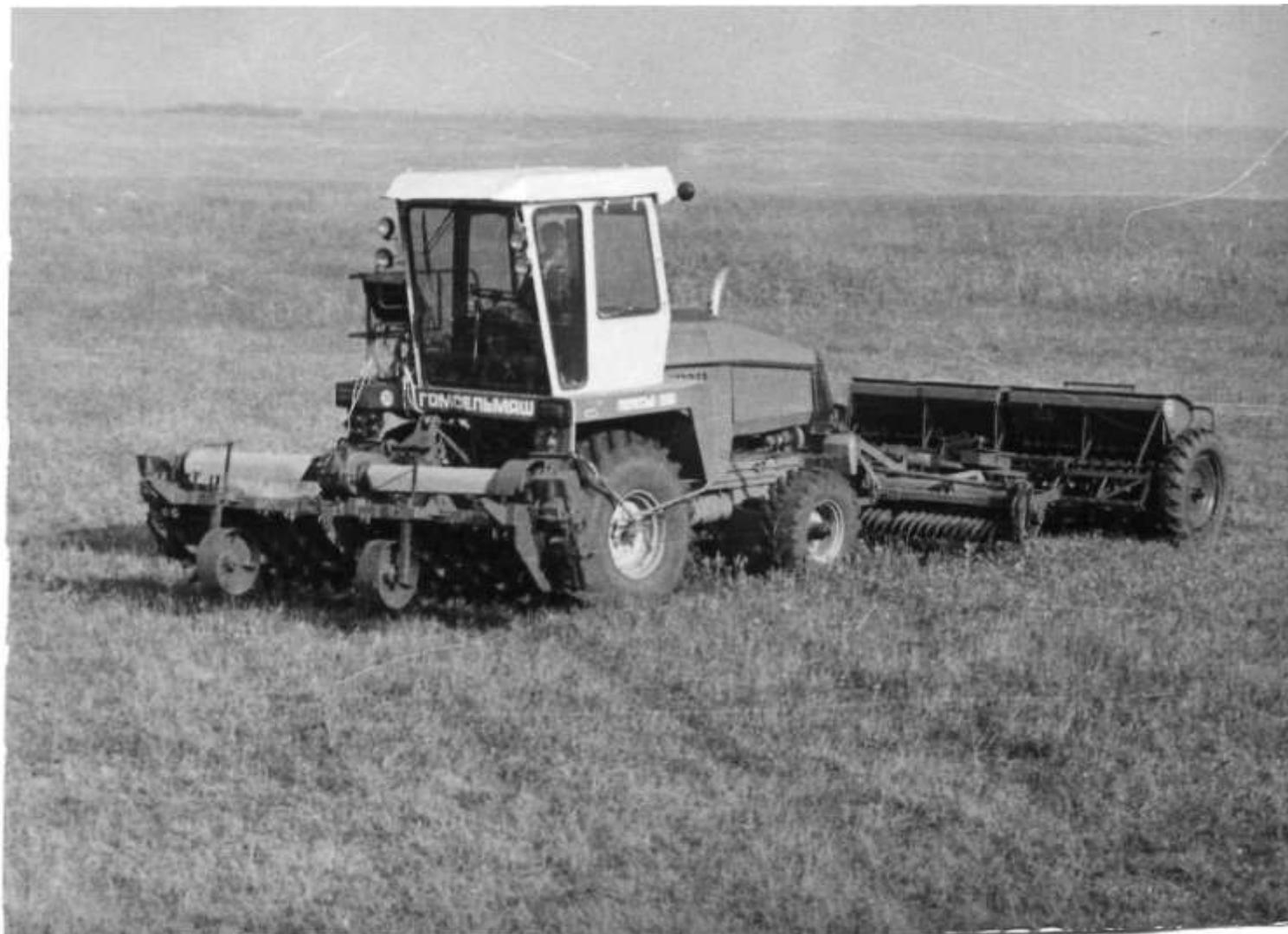
**Комбинированный агрегат ускоренного залужения АЗ-3,6
