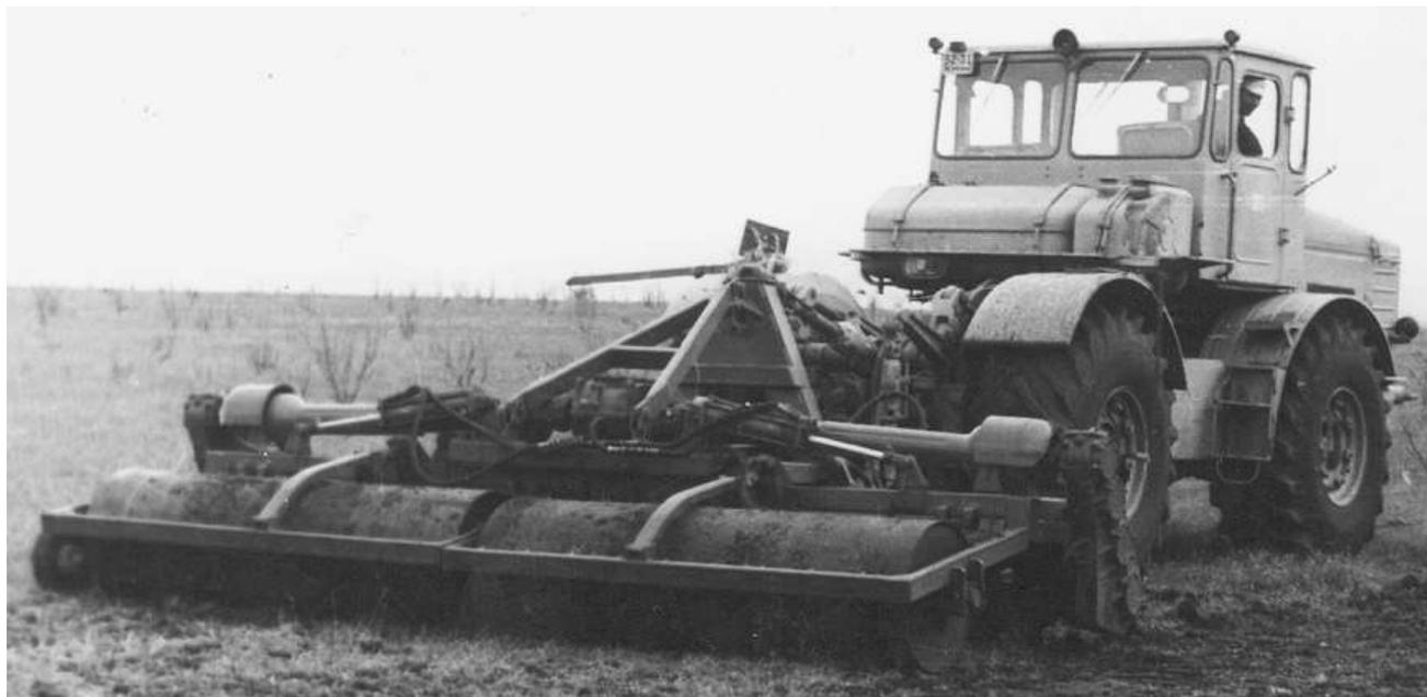
**Фрезерная машина ФПП-4,2 со специальным катком для качественной обработки переуплотненной почвы и выравнивания**
