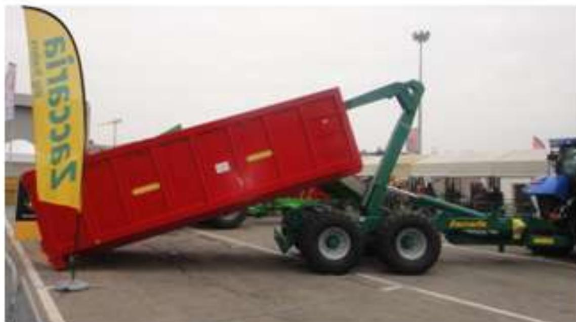
Шасси для загрузки-разгрузки транспортных емкостей фирмы типа ВИМ лифт
