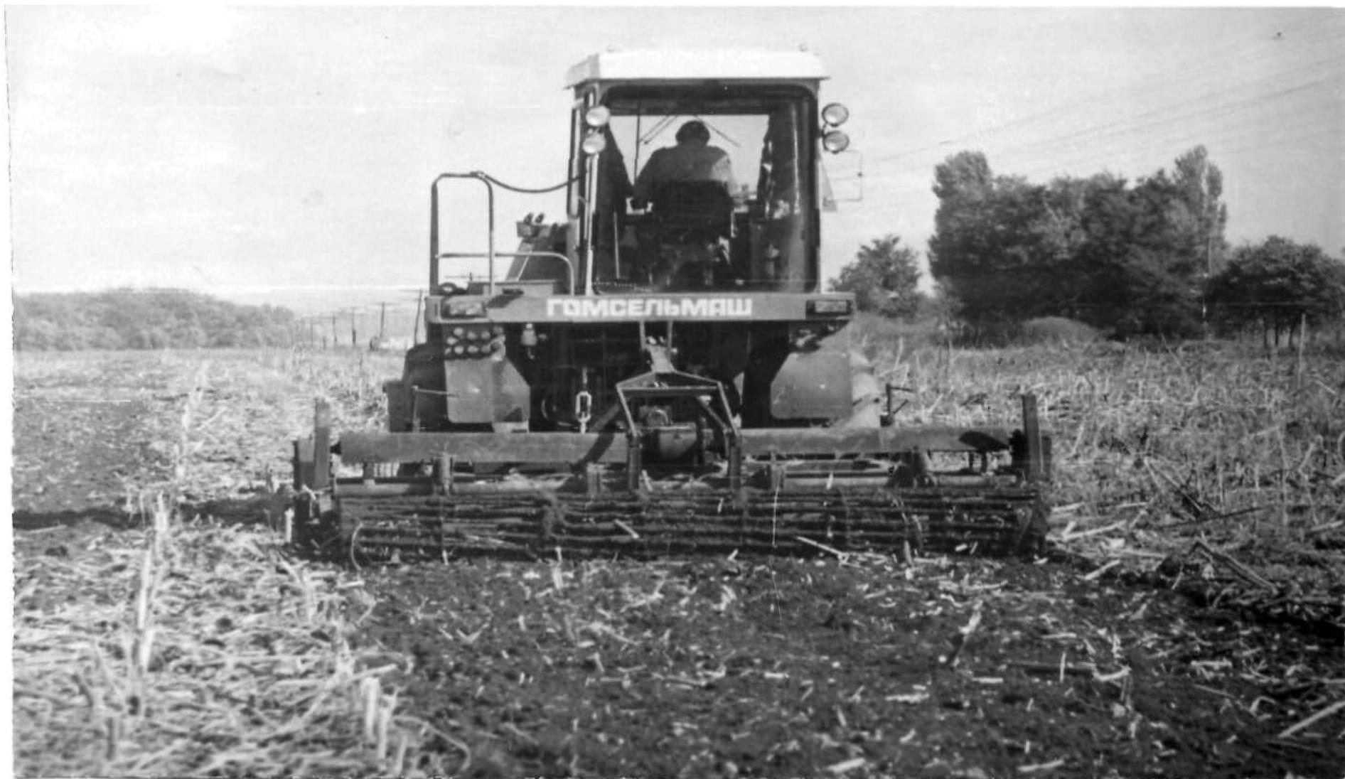
**Комбинированный агрегат для чизельной обработки полевых почв фронтальным ротационным плугом ПР-2,7 и задненавесной фрезерной машиной ФП-3,0**
