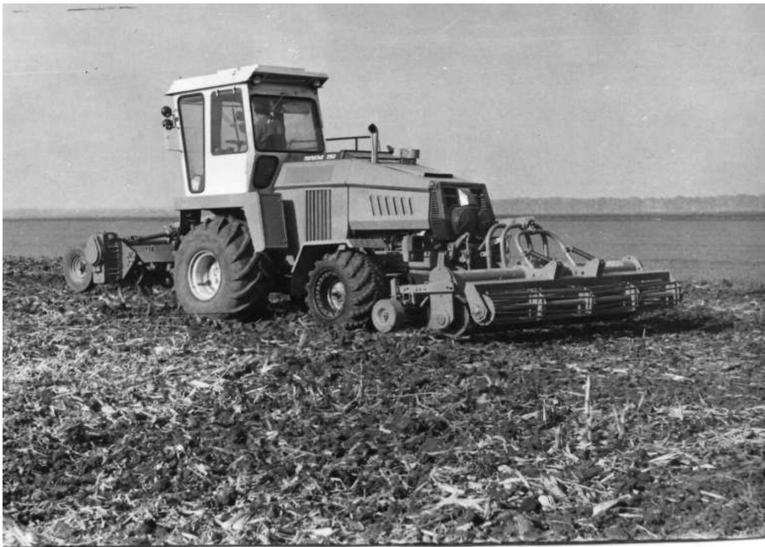
**Комбинированный агрегат ускоренного залужения АЗ-3,6
